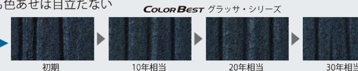
20年相当の試験をして劣化させた有機塗装の屋根材です。(写真はイメージです)
